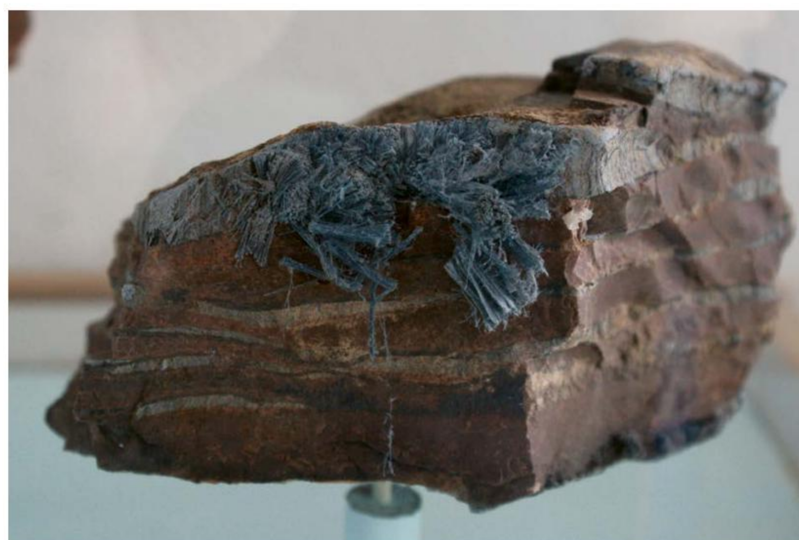
Onder: natuurlijk voorkomen van asbest: crocidoliet op gelaagde ijzersteen. © ETWIE
